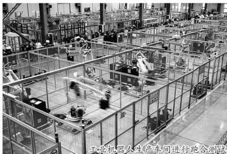
工业机器人生产车间进行跑合测试
