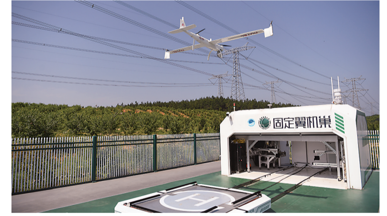
垂直起降固定翼机巢是部署在输电线路附近地面上的固定机巢，内部搭载一架依靠螺旋桨垂直起降、固定翼巡检飞行的无人机，机巢可自动收放无人机、更换电池、自主巡航周边环境等，从而实现重要输电通道无人值守的全自动智能巡检作业。 新华社发
