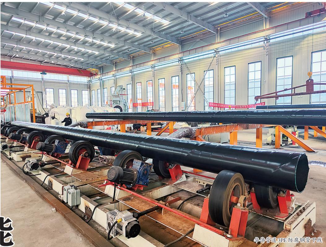
华伟管道3PE防腐钢管下线
