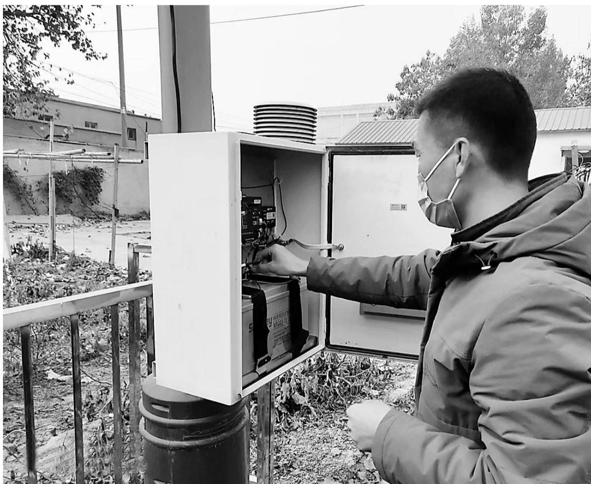
近日，肃宁县气象局组织技术人员对辖区9个自动气象站进行了全面维护，确保冬季区域站上传数据的及时性、准确性和可靠性，为做好冬季气象服务工作提供有力支撑。孙诗明 摄
