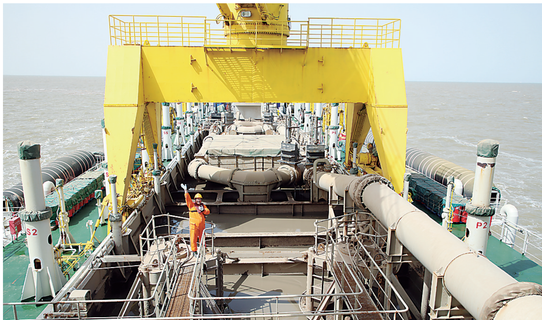
随着抛泥指令的下达，泥舱里的泥沙在30秒内倾泄完毕。
