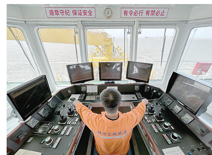
在驾驶室内，操把手石育华操控船身两侧的耙头伸向航道底部。
