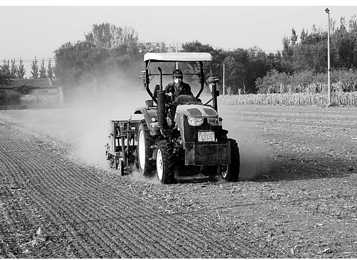
在泊头四季飘香农业种植场，农机手正驾驶着装有北斗定位系统的农机播种小麦，不仅播种进度快，种子间距、深度等均整齐划一，有效提升了作业效率。 毛长林 李智力 摄
