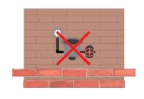
不要将燃气管道、阀门、燃气表、燃烧器具等燃气 设施密封或安装在墙壁、吊顶、厨柜内。
