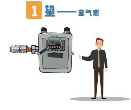
关闭家里的燃气具,在不用气的情况下,如果气表 的末位红框内数字走动,则可判断为燃气有泄漏。
