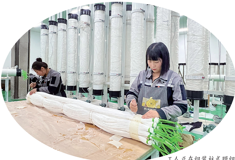
工人正在组装柱式膜组件
