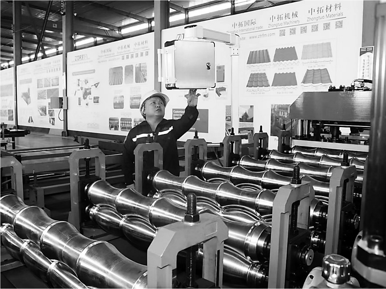
在泊头市的一家压型机械生产公司里，工人在加紧调试即将发往国外的彩钢立缝成型机。这些设备安装了先进的云系统，实现了数据实时监控与远程管理。
