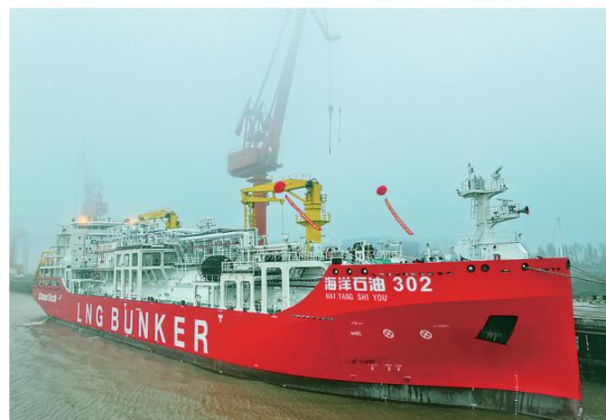
4月28日在中集太平洋海工码头拍摄的“海洋石油302”（无人机照片）。当日，由南通中集太平洋海工为中海油建造的12000立方米LNG运输加注船“海洋石油302”在江苏启东海工船舶工业园顺利交付。该加注船总长132.9米，货舱总容量达12000立方米，具有“江海直达”“冰区航行”等性能优势，将为我国江域、海域液化天然气船舶提供灵活的加注服务。新华社发
