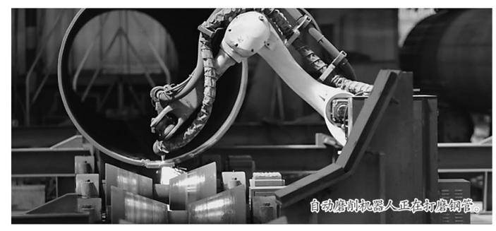
自动磨削机器人正在打磨钢管。今后,我们将继续大力实施科技创新,加快发展新质生产力。通过加强核心技术升级,加快新品研发,优化技术工艺,加大机器人在各个岗位的应用,提高生产效率和产品质量。”安晓军表示。
