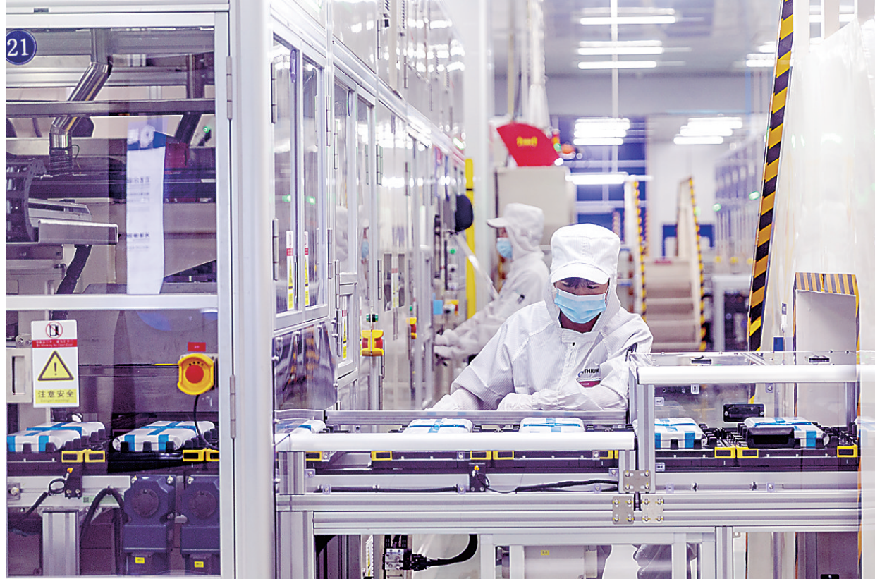
工人在生产线上检测两个电芯是否匹配 新华社发
