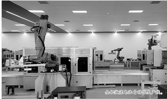
全钒液流电池自动化生产线。
