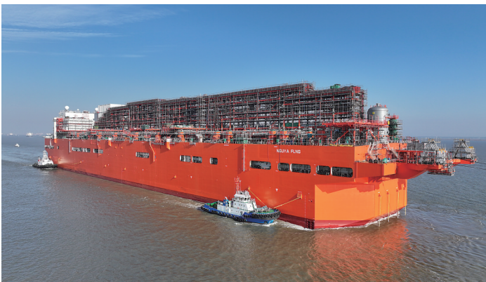
12月9日，我国首座大型浮式天然气液化装置“NGUYA FLNG”轮从江苏南通开发区顺利拖航出江，前往浙江舟山进行上部模块安装、集成和调试。据了解，浮式天然气液化装置（FLNG）能够在深远海直接将开采出的天然气液化并储存，是海洋工程装备中建造复杂、附加值大的一类产品。 图为大型浮式天然气液化装置“NGUYA FLNG”轮在拖轮拖带下行驶在长江江苏太仓段（无人机照片）。 新华社发
