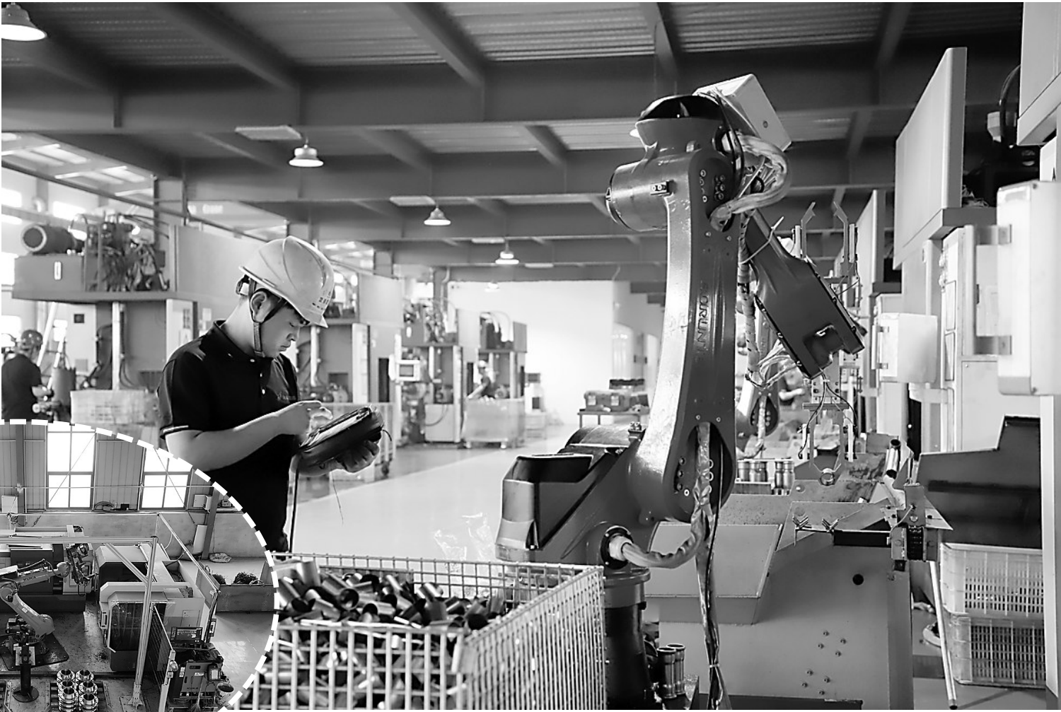
▲河北龙锦管道装备有限公司生产车间内，工人正在调试水涨成型机器人。
