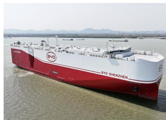
3月31日,汽车运输船“深圳号”完成试航归来(无人机照片)。4月22日,中国新能源汽车龙头企业比亚迪第四艘汽车运输船“深圳号”(BYD SHENZHEN)在江苏仪征正式交付。该船是比亚迪的第四艘专业汽车运输船,由招商局旗下金陵船厂制造,总长219.9米,型宽37.7米,共16层甲板,拥有9200个标准装载车位,是目前已投入运营的全球装载量最大的汽车运输船。新华社发
