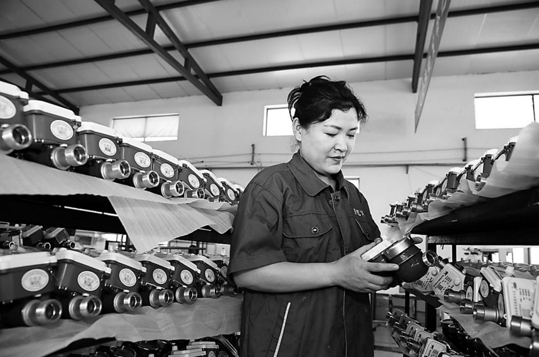
近日,在泊头市普惠仪表有限公司内,工人正在对物联网智能水表产品进行检测。据介绍,这家企业专门为农村水务系统研发的智能水表,拥有电信、蓝牙双传输系统,深埋地下也不影响信号传输,可有效保障数据精准采集,使农户用水管理更加高效。
